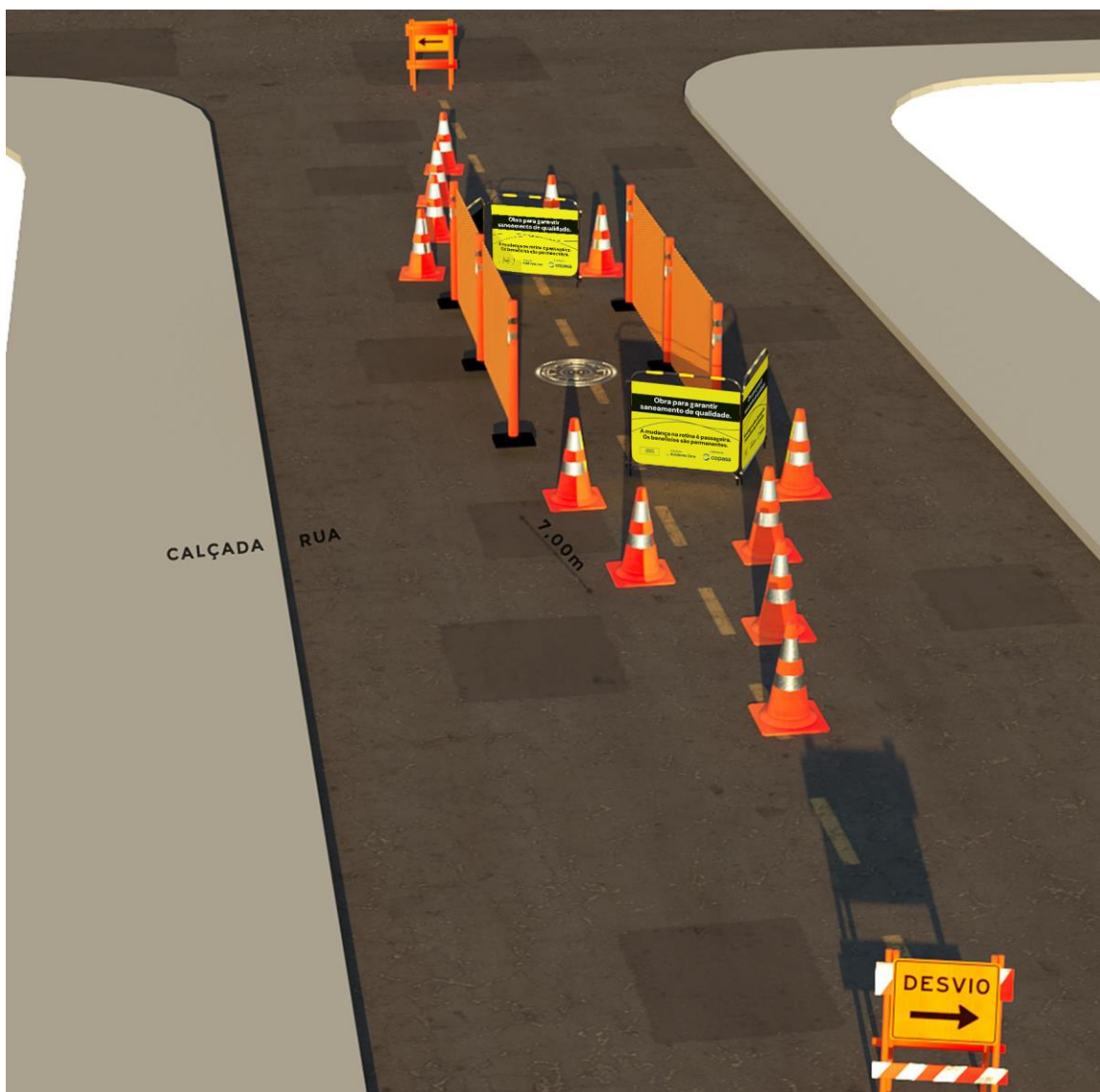
Figura 2 - Sinalização em pista de sentido duplo (meio da via)
