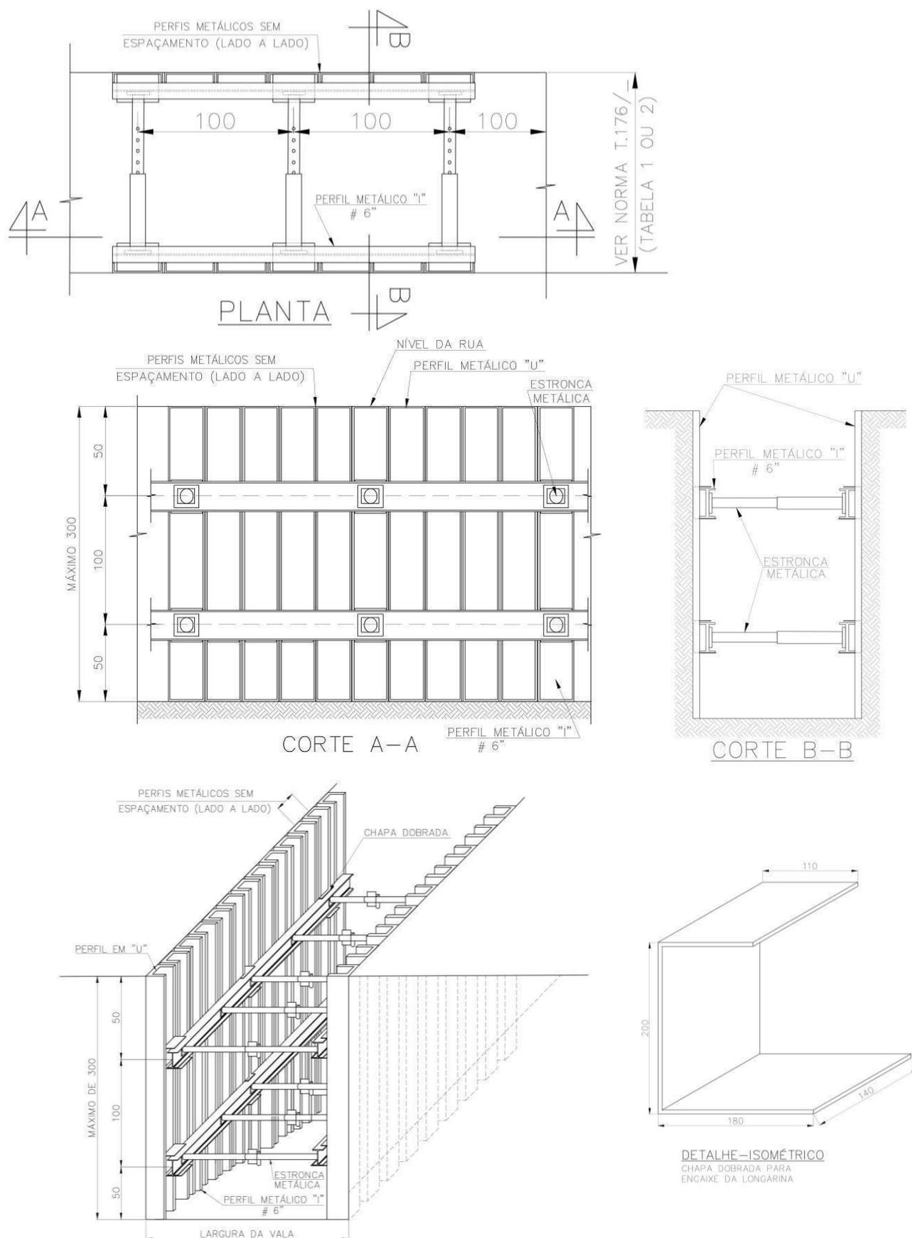
Figura 4 – Contínuo Metálico com Longarina
