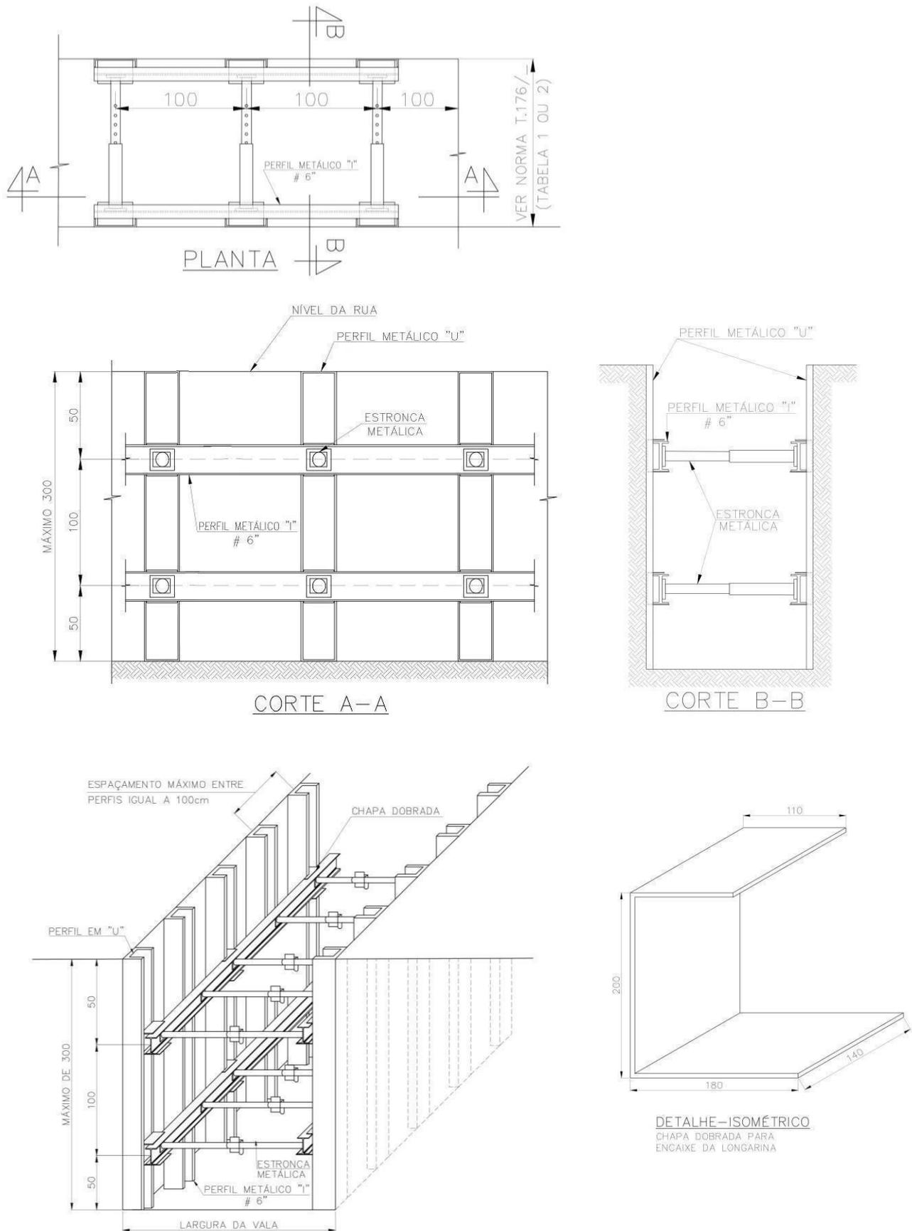
Figura 2 – Pontaiteamento Metálico com Longarina
