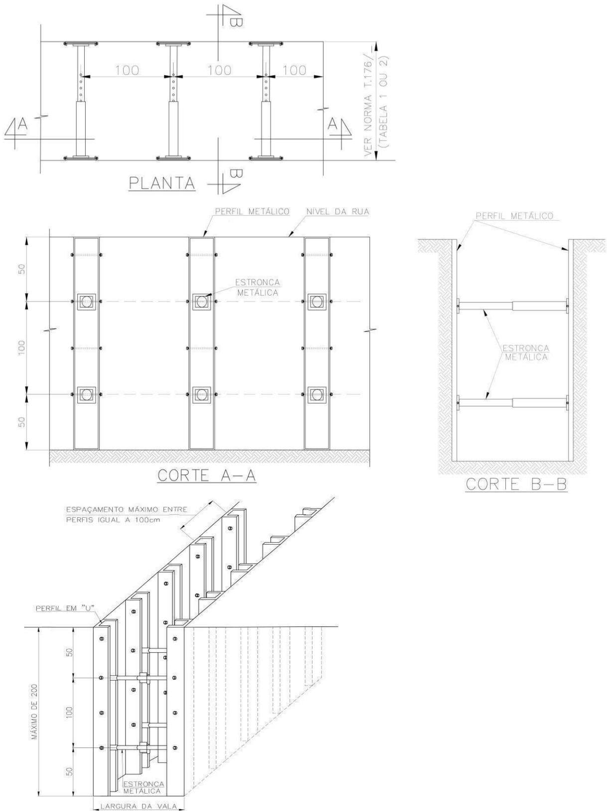
Figura 1 – Pontaiteamento Metálico até 2,00m de profundidade
